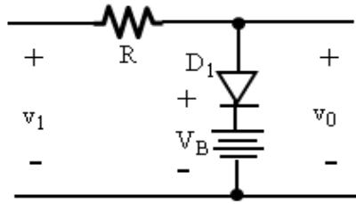
When  $V_i > V_B + V_\gamma$
